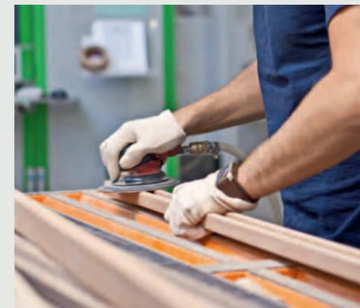
Das gesamte Interieur einer BAVARIA, von der Holzleiste aus Massivholz in jeder Kabine bis zur kompletten Pantry, wird von den erfahrenen Bootsbauern des Unternehmens in einer eigenen Werkstatt selbst gefertigt. Jedes Holzteil einer BAVARIA wird auf einer eigenen Lackierstraße bis zu sechs Mal lackiert.
