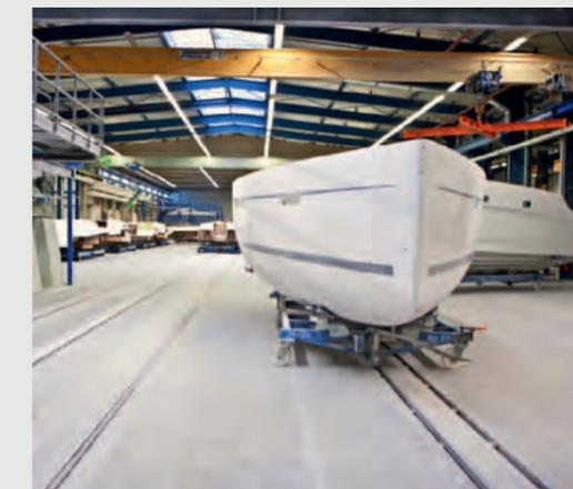
Rumpf und Deck einer BAVARIA bestehen aus einer Sandwichkonstruktion mit Schaumeinlagen. Wo Beschläge montiert werden, ist das Deck mit Aluminiumplatten verstärkt. Über moderne Transportsysteme durchlaufen Deck und Rumpf zunächst getrennt die Produktion, bevor sie miteinander verschraubt und verklebt werden.
