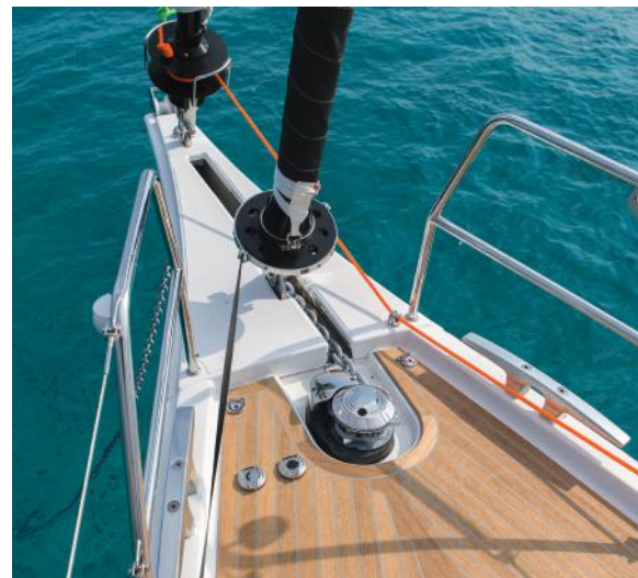
Fixed bowsprit for downwind sails mounting Delphinière fixe pour amurage des voiles de portant
